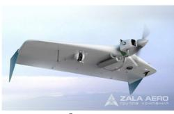
Данная модель беспилотного самолета отличается высокой продолжительностью непрерывного полета - 4 часа (при двухтактном двигателе) и 8 часов (при четырехтактном двигателе) и большой скоростью - 130-200 км/ч. БЛА, в отличие от конкурирующих моделей в своей весовой категории, обладает возможностью покрывать большие расстояния за один полет. Появление ZALA 421-16 ставит ПОД сомнение актуальность использования аэродромного базирования и открывает новую эпоху
