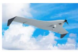
Беспилотный самолет тактической дальности системой автоматического управления (автопилот), навигационной системой (GPS/ГЛОНАСС), встроенной цифровой системой телеметрии, навигационными огнями, встроенным трехосевым магнитометром, цифровым встроенным фотоаппаратом, цифровым широкополосным видеопередатчиком C-OFDM-модуляции, радиомодемом с приемником СНС <Диагональ ВОЗДУХ> с возможностью работы без сигнала СНС (радиодальномер), системой
