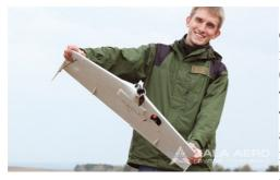
Беспилотный самолет тактической дальности с системой автоматического (автопилот), управления навигационной системой с инерциальной коррекцией (GPS/ГЛОНАСС), встроенной цифровой системой телеметрии, навигационными огнями, встроенным трехосевым магнитометром, удержания модулем активного сопровождения цели (Модуль АС), цифровым встроенным фотоаппаратом, цифровым широкополосным видеопередатчиком C-OFDM-модуляции, радиомодемом с
