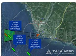
Благодаря интегрированной системе AIS, беспилотные летательные аппараты обнаруживают и идентифицируют суда на удалении до 100 км, что в несколько раз превышает радиус действия наземной станции управления. Таким образом, оператор БЛА получает дополнительную информацию о каждом судне — название, габариты, курс и скорость.
