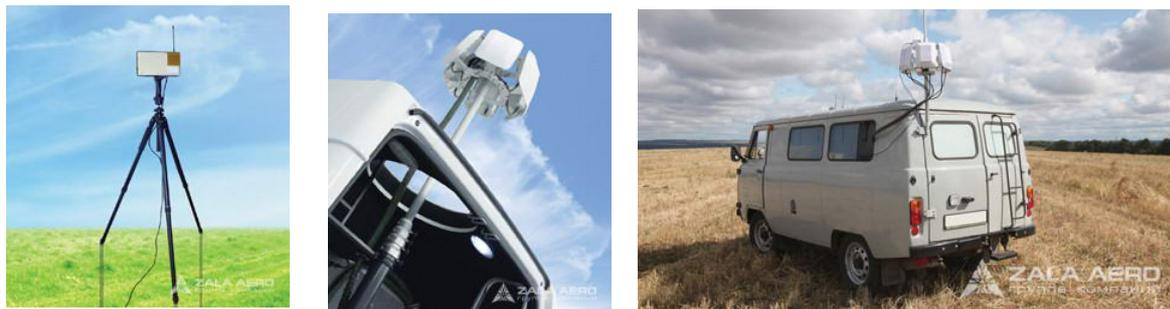
Всенаправленные приемо-передающие антенно-фидерные устройства, следящие за местоположением беспилотного летательного аппарата. Компактные размеры антенн позволяют осуществлять их транспортировку в стандартном микроавтобусе и разворачивание на базе транспортного средства.
