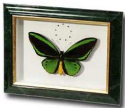
Индикатор электромагнитного поля, выполненный (закамуфлированный) в виде настенного панно с бабочкой.
