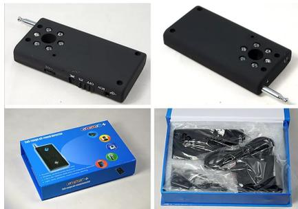
Детектор (сканер) скрытых камер и радиожучков, предназначен для обеспечения защиты от несанкционированного прослушивания помещения, например: офиса, квартиры, гостиницы и т.д., путем обнаружения активности радиочастотного сигнала в широком диапазоне частот от 1-го мегагерца до 6,5 гигагерц.
