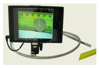
Видеоэндоскопы серии ВСР-АЦ предназначены для осмотра внутренних полостей контролируемых изделий и объектов в труднодоступных местах.
