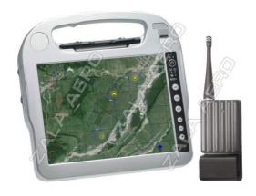
Полноценный компьютер, позволяющий составлять полетное задание, управлять беспилотным летательным аппаратом. Кодированное беспроводное соединение между приемопередающей антенной и НСУ позволяют оператору свободно перемещаться и управлять аппаратом из удаленного укрытия.
