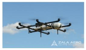
Беспилотный вертолет средней дальности с системой автоматического управления (автопилот), навигационной системой (GPS/ГЛОНАСС), встроенной цифровой системой телеметрии, навигационными огнями, встроенным трехосевым магнитометром, модулем удержания и активного сопровождения цели (Модуль АС), цифровым широкополосным видеопередатчиком C-OFDM-модуляции, радиомодемом с приемником СНС (Диагональ «ВОЗДУХ»), системой самодиагностики и поисковым передатчиком.
