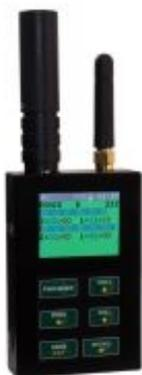
ST 110 детектор поля предназначен для обнаружения и локализации радиоизлучающих технических средств (РТС).
