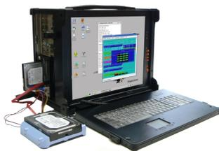
Переносной специализированный комплекс с высокими характеристиками, предназначенным для криминалистической экспертизы цифровых носителей данных. При тестировании на практике OneCorder достигает скорости копирования диска до 7ГБ в минуту.
