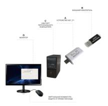
**Key\_P1 MultiClet** - многофункциональное устройство для защиты информации на ПК и накопителях, разработанное на базе мультиклеточного процессора с универсальной не фоннеймановской архитектурой. Выполнено в виде миниатюрного блока с тремя разъёмами: USB — розетка и вилка, а также разъём для SD-карт. Количество инициируемых обычных флешнакопителей не ограничено.
