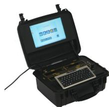
Программно-аппаратное криминалистическое средство для скоростного копирования данных с возможностью их предварительного анализа. Устройство ДатаКоп представляет собой компактный специализированный переносной компьютер в противоударном пластиковом корпусе со встроенным дисплеем, имеющий специально разработанные модули для быстрого и достоверного копирования данных с устройств SATA, SAS и USB 3.0.
