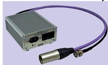
Автоматический коммутатор входных сигналов предназначен для гальванической развязки входных цепей прибора; для переключения входов; для ручного и автоматического перебора возможных комбинаций контактов; для обеспечения (при необходимости) ослабления входного сигнала; для формирования напряжения смещения.
