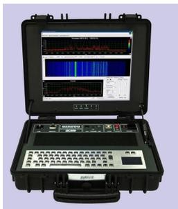
Комплекс "СИРИУС" (третье поколение) предназначен для обнаружения и анализа сигналов в проводных линиях и в подключенных к ним электронных устройствах, возникающих как за счет прямого формирования, так и путем акустоэлектрических преобразований, а также для проведения комплексных электротехнических измерений проводных коммуникаций.
