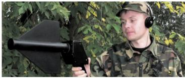
Предназначен для оперативного поиска, пеленгования и определения координат источников радиоизлучений в диапазоне частот 20 ... 3000 МГц
